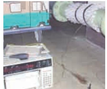
輸送配管の稼働実態計測
