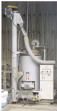
切り替え時発生物の乾燥装置 (知多工場)
