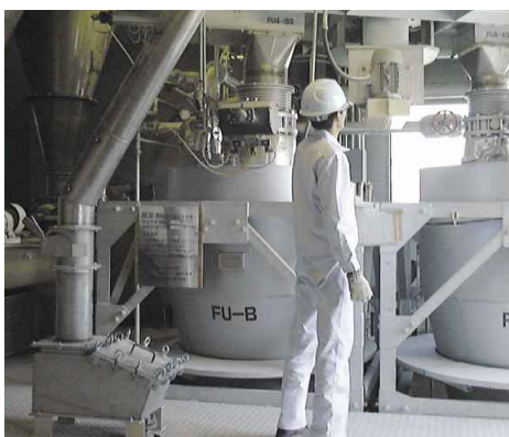
加圧蒸気添加方式によるフレーク製造設備 (小樽工場)
