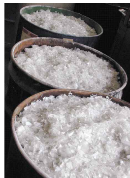
分別した蛍光灯のガラス(委託業者)
