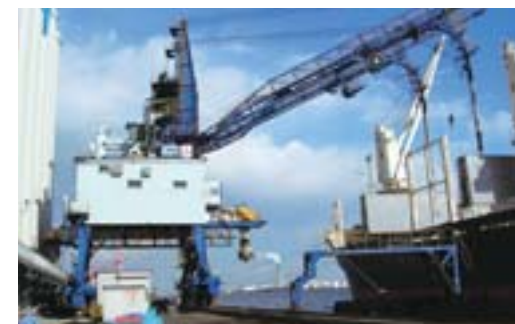
穀物用アンローダー(吸引式荷揚装置)に免震装置を導入
